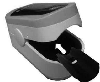
血液はヘモグロビンが酸素と結合すると赤くなり、酸素を失うと黒くなる。発光ダイオードの2波長の吸収される割合が異なることを利用し、動脈拍動を感知し、血液中の酸素量を測定する。
